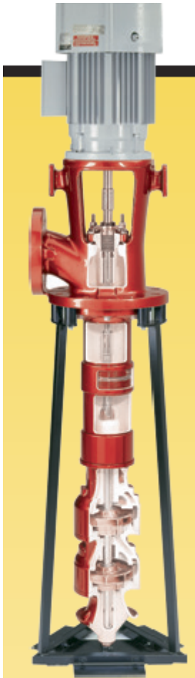
Vista interior de una Turbina, donde se observa: motor, cabezal de descarga, flecha, columna y cuerpo de tazones.
